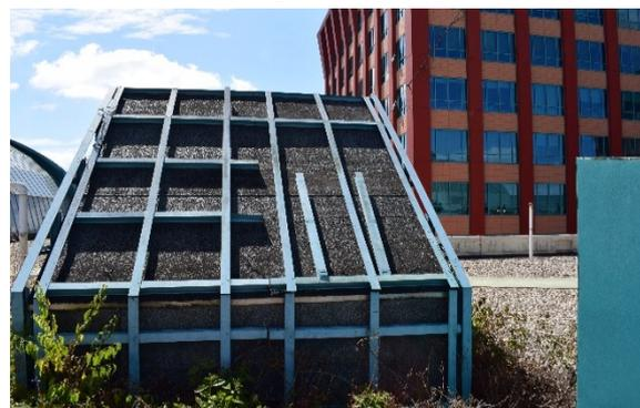
(d) Profiles removed for specimen extraction
